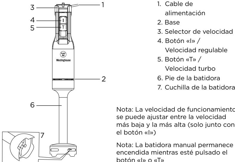
Nota: La velocidad de funcionamiento se puede ajustar entre la velocidad más baja y la más alta (solo junto con el botón «I»)
